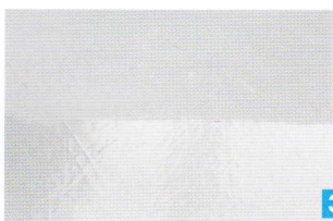
●上がFRP板の表面にサンダーで足付けした状態。FRPに塗装するときは、きちんと足付けしないと塗料の乗りが悪くなるので注意
